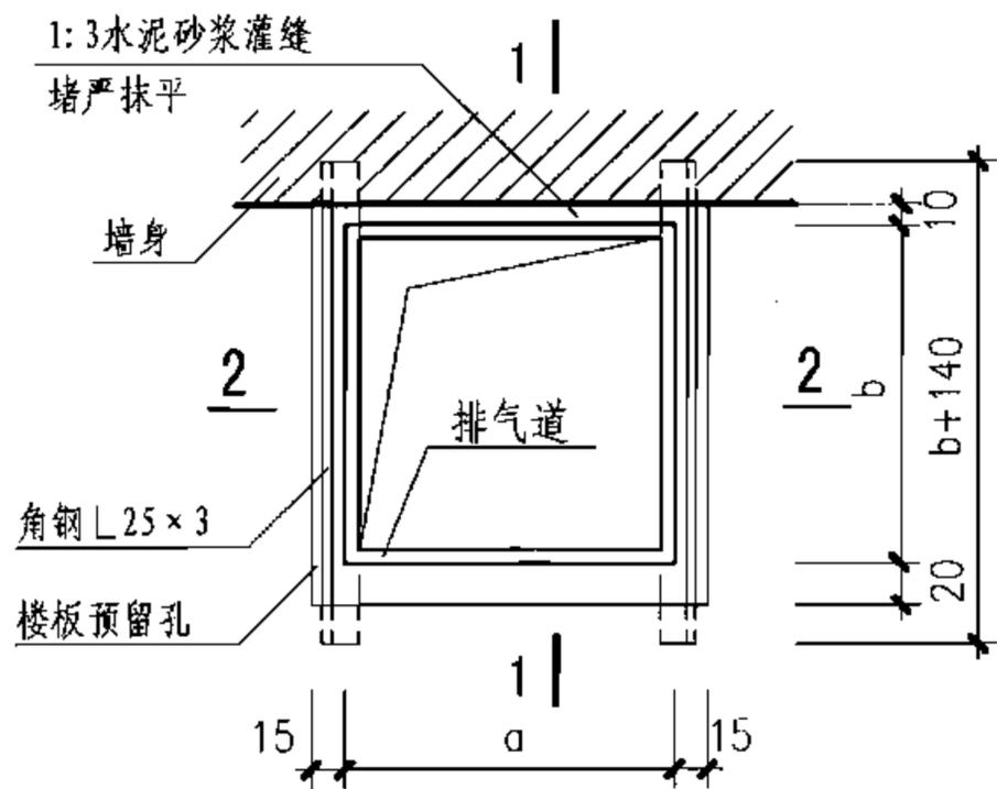
排气道楼板处连接平面图
