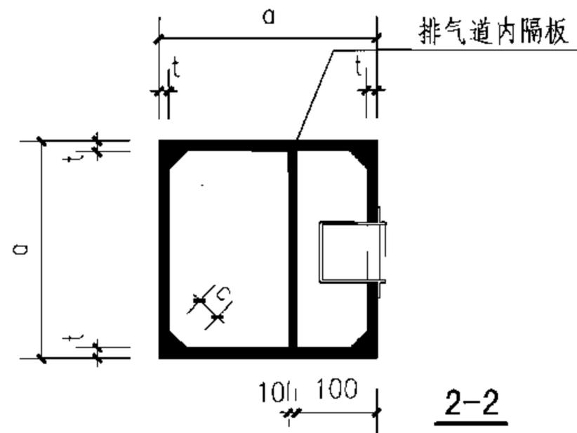
E型九层及九层以下卫生间内设排气道详图、选用表
