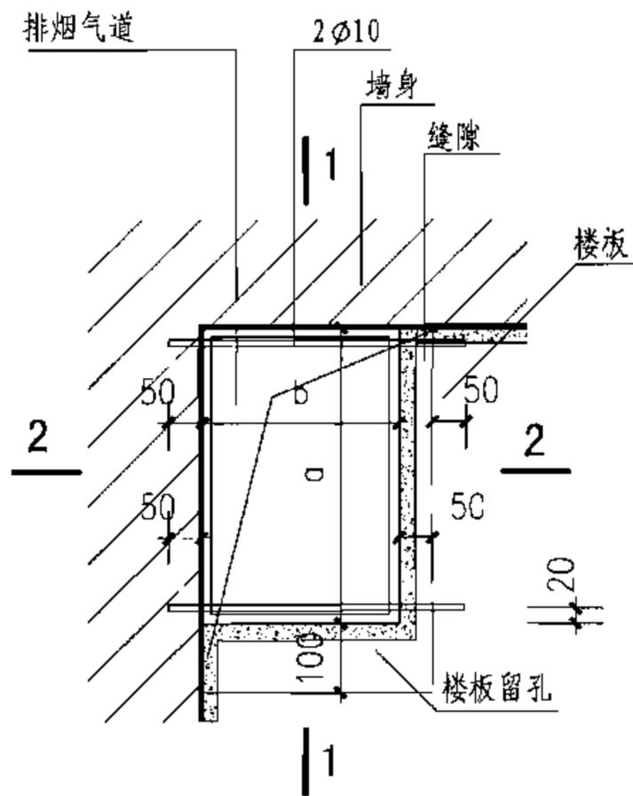
楼板留孔安装示意平面
