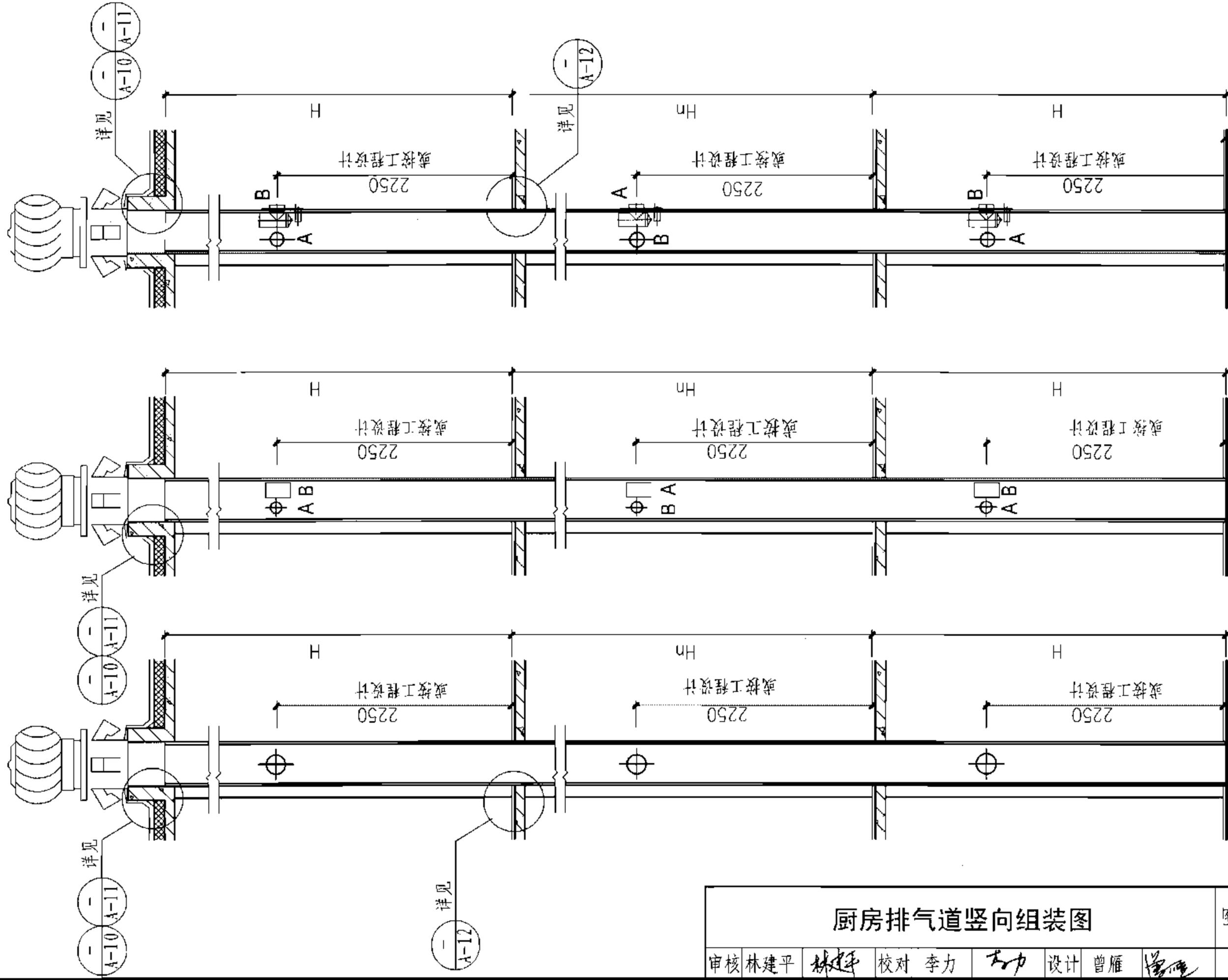
A-C型排气道组装图    A-CS型排气道组装图    A-CS型排气道组装图    A-CS型排气道组装图
