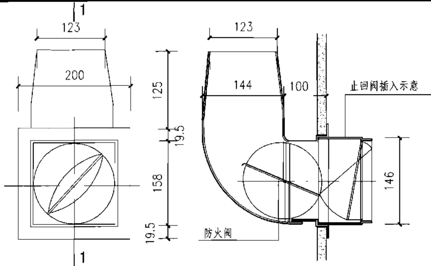
① 射流引射接力装置立面
