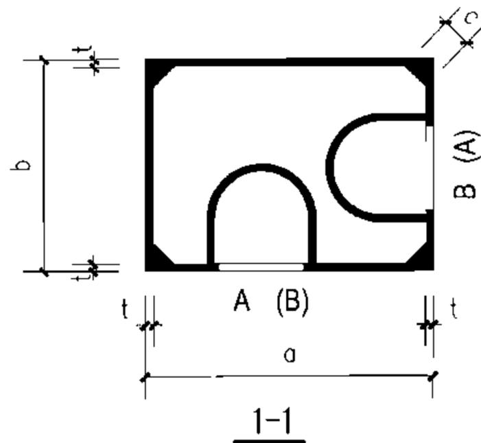
说明: 1. 每层用一根排气道, 排气口设在排气道长边或短边均可, 工程设计人员提供厨房平面及进气口方向, 由加工厂根据平面安排生产并编号。
