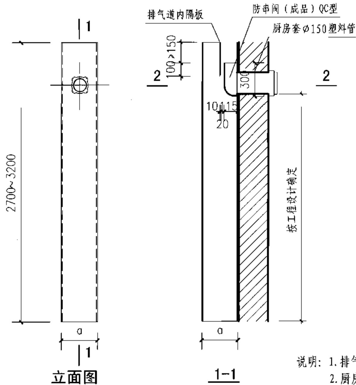
说明: 1. 排气管道按层高一段加工, 加工长度等于层高-6。
