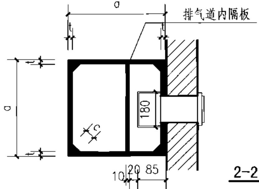
E型九层及九层以下卫生间外设排气道详图、选用表
