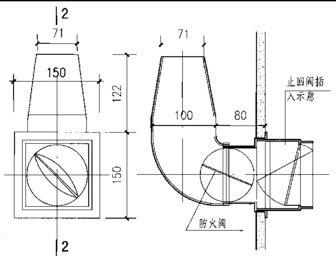
② 射流引射接力装置立面
