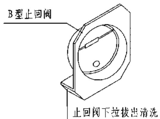
B型止回阀安装示意
