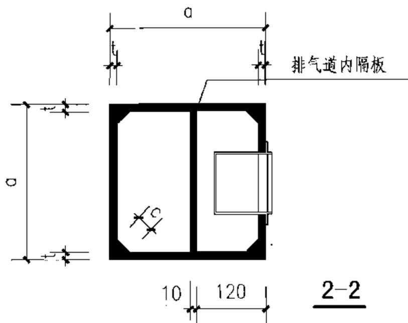
E型九层及九层以下厨房内设排气道详图、选用表 图集号 07J916-1
