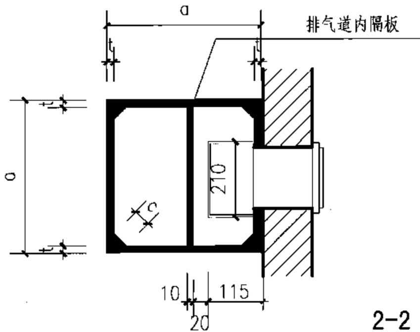
E型九层及九层以下厨房外设排气道详图、选用表 图集号 07J916-1
