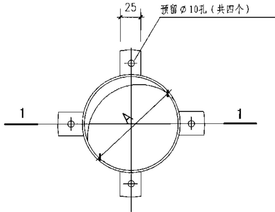
无动力排气风帽底座接口钢板圈
